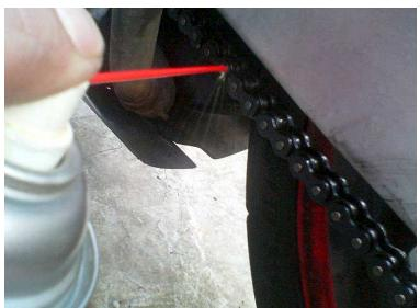
5) チェーン以外に飛散した部分は、早めにチェーンクリーナーを吹き付けて掃除をしておきます。
